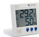
Termohygrometer EMR 812HGN - visar temperatur och fukthalt
